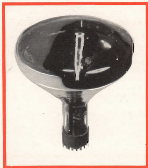
Fig. 1a - Fotomoltiplicatore 57 AVP per flying-spot.
