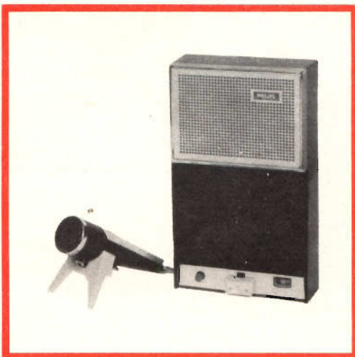
Fig. 7 - Esempio di registratore portatile a nastro, funzionante a transistori, di produzione Philips.
